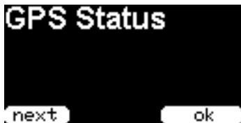
右の "ok" ボタンを押すことによって、以下の GPS 衛星から受信した位置情報の表示画面に移ります。
