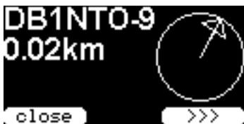
“Follow”を選択すると、受信した局までの距離と相対的な位置関係が表示されます。例えば、自局が相手局の方向に進んでいる場合、矢印は上を向いて表示されます。新しい位置情報を受信した場合、表示は自動的に更新されます。この画面は GPS データメニューから開くことができます。PicoAPRS をリセットしない限り、最後に受信した局のデータが保存されています。
