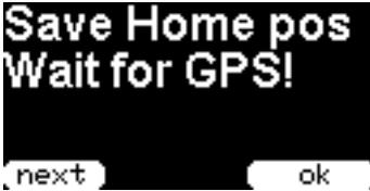
もし、GPSが受信できない場合、2行目に"Wait for GPS"と表示します。2行目に"Ready for save"と表示されている場合に、右ボタンの"ok"を押すことによって位置情報を保存できます。
