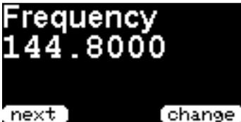
APRSの送受信に使用する周波数を指定します。出荷時には欧州で使用する144,800 MHzに設定されていますので、適宜変更してください。コールサインの入力画面と同じように入力します。最初の2桁(14)と小数点は固定です。
