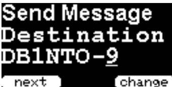
"SendMessage" で新たにメッセージを送ることができます。最初に宛先を指定します(コールサインとSSID)。自局のコールサインを入力する画面と同じような方法です(メニュー"MyCall"をご覧ください)。コールサインを入力し終わり、チェックマークを入力するとハイフオンが自動的に表示され、SSIDを入力することができます。
