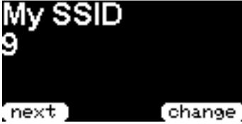
"change"ボタンを用いることによってご自身のSSIDを設定できます。使用できるのは、0から16までです。SSIDは局のタイプを識別するために用いられます。
