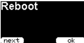
もし、お使いの PicoAPRS が通常どおりの動作をしなくなった場合、メニューからリスタートを行うことができます。各種設定は削除されません。もし、リブートでも回復しない場合、内蔵バッテリーを外し、そして USB 接続状態であれば、USB ケーブルも外して、数秒後にバッテリーを再接続してください。
