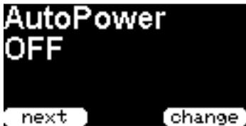
オートパワーで **"Power Off"** を選択し、USB から電源が供給されない場合、PicoAPRS はオフになり、USB 接続するとオンになります。車のシガレットライター端子から USB パワーを供給した場合も同様です。
