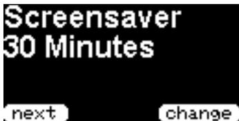
スクリーンセーバーは、設定した一定時間、ボタンが操作されなかった場合に LED ディスプレイを OFF にします。もちろん、この間も PicoAPRS は動作しており、ボタンが操作された場合に、ディスプレイが再び表示されます。この場合、最初のキー押下は操作に影響しません。
