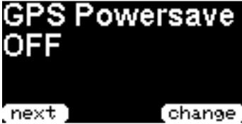
"GPS Powersave" は GPS が必要ない場合に GPS 受信機を自動的に OFF するかどうかを設定します。"OFF" はパワーセーブ機能を動作させないようにします。"ON" では、パワーセーブ機能を動作させます。
