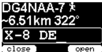
第1行目: コールサイン、SSID、および受信した局の APRS シンボルを表示します。
