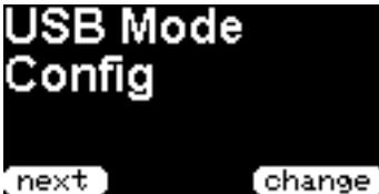
USB モードでは、PC 側からみた振る舞い選択できます。選択できるのは、Config(設定)、GPS、KISS TNC のいずれかです。PC との通信速度は **115200 baud** です。
