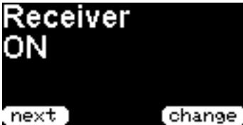
内蔵された受信機をオン、もしくはオフにします。”オフ”の状態でも位置情報ビーコンは送信されます。受信機はAPRSパケットとメッセージの受信に使用します。PicoAPRSをKISS-TNCとして使用する場合、受信機は自動的にオンとなります。
